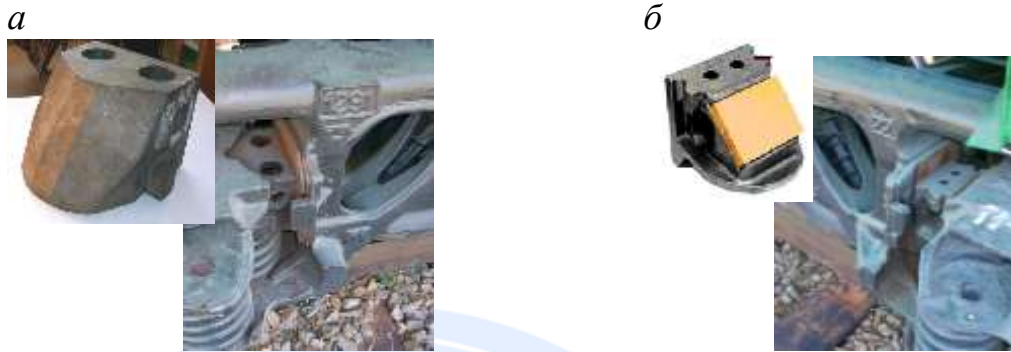
Рисунок 18 – Просторовий (а) та плоский з полімерною накладкою (б) фрикційні клини ресорного підвішування
